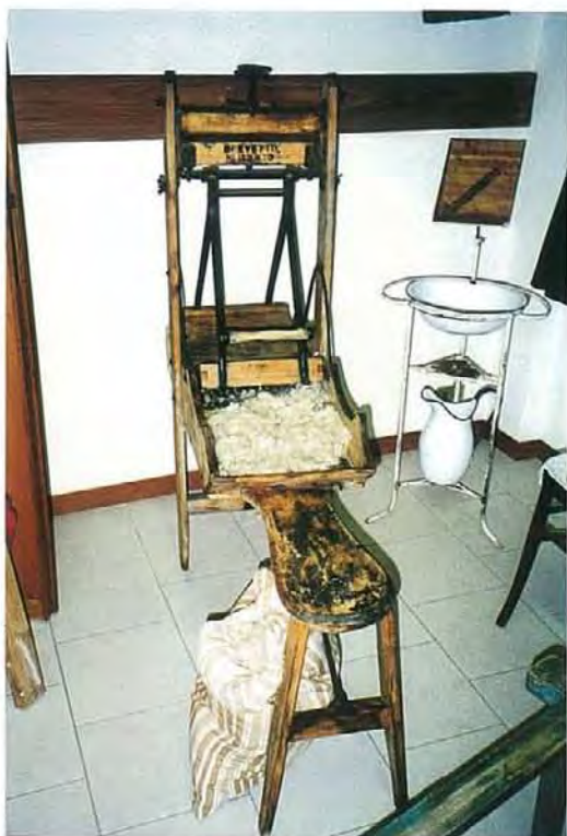
Macchina per cardare la lana
