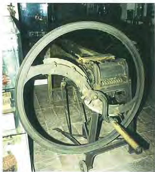
Macchina sgranatrice del frumento (foto: M. e M. Adovasio)
