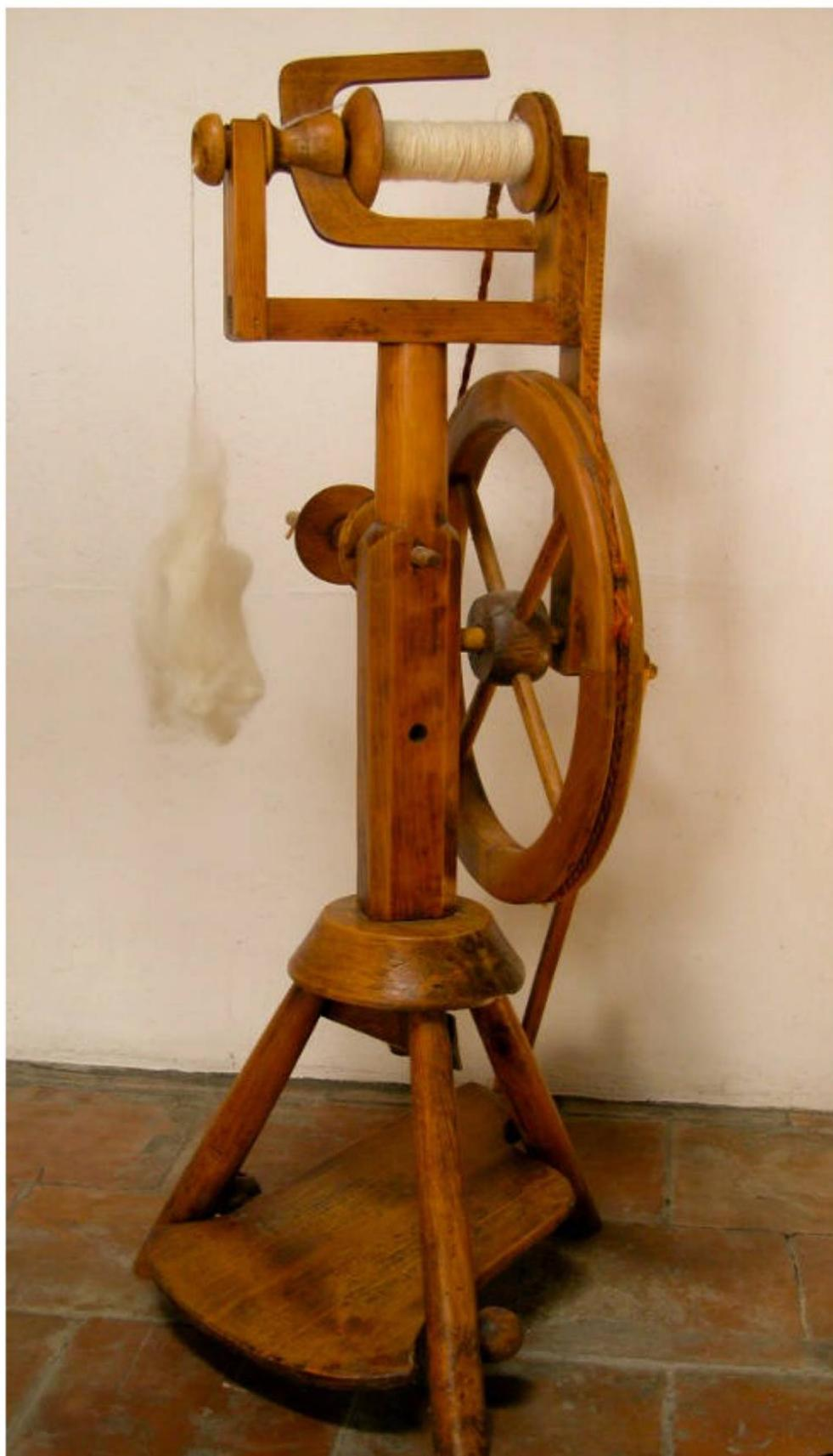
riuscita del lavoro. Se non è sufficientemente veloce si avrà la rottura del filo, se lo è troppo si otterranno ispessimenti o grumi.
