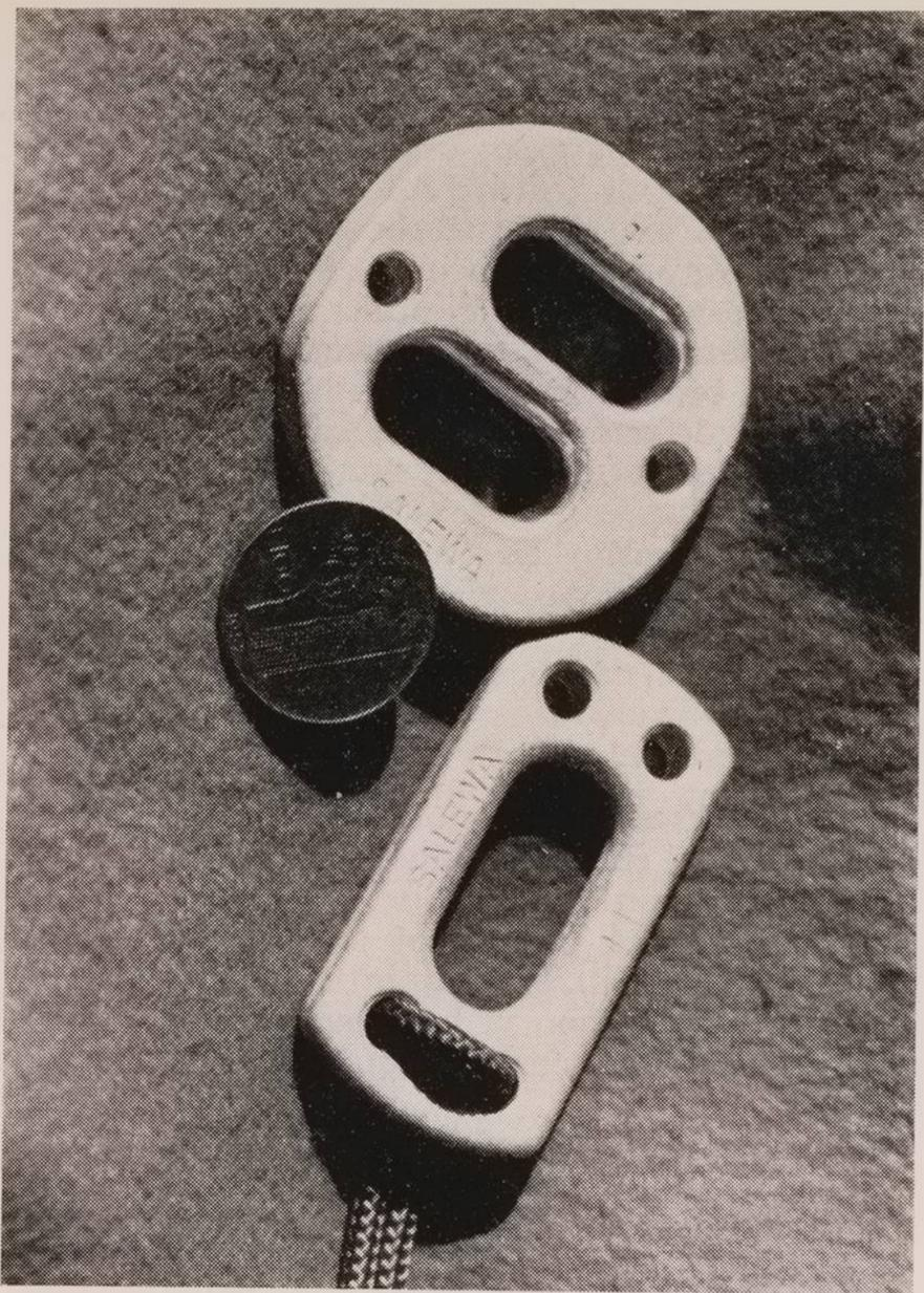
Ecco due tipi di «freno Sticht» della SALEWA: il tipo a due fori per due corde da 9 mm e il tipo a un solo foro per una corda da 11 mm, quest'ultimo con la funicella (cordino da 3-4 mm) per assicurarlo alla cintura o al chiodo.
