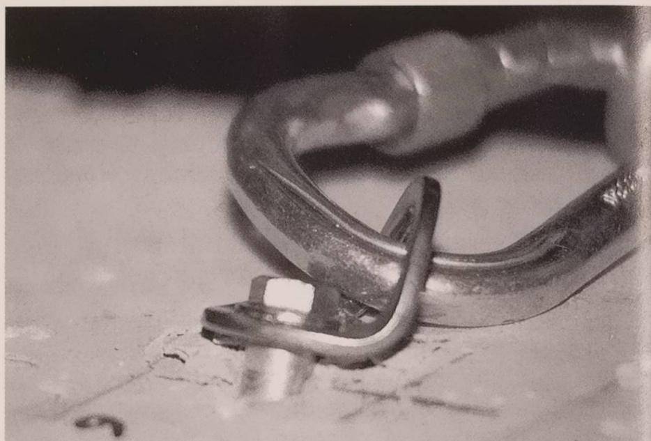
senta segni di piegamento nel senso della trazione stessa e la perdita dei primi filetti dato che lo spessore della piastra ne ha ridotto notevolmente lo spessore di avvitamento. Lo spit invece è rimasto infisso e solo una parte della camicia si è frantumata (foto n. 4).
