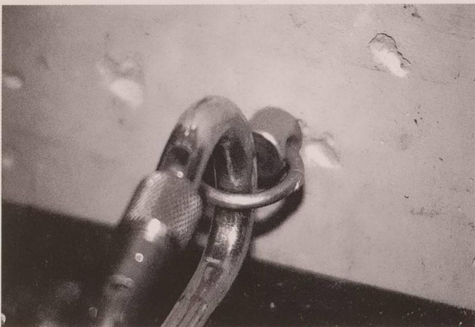
Si ricorda che le norme sopra citate (vedi LAV '91-92) prescrivono di svolgere tre volte ciascuna prova ed in ognuna il superamento con trazione in direzione radiale di circa 2500 kg ed in direzione assiale di circa 1500 kg.
