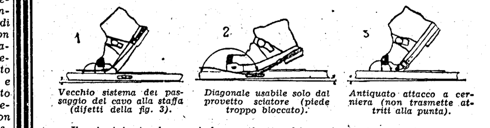
Vecchio sistema del passaggio del cavo alla staffa (differenza fig. 3). Diagonale usabile solo dal provetto sciatore (piede troppo bloccato). Antiquato attacco a cerniera (non trasmette attriti alla punta).
