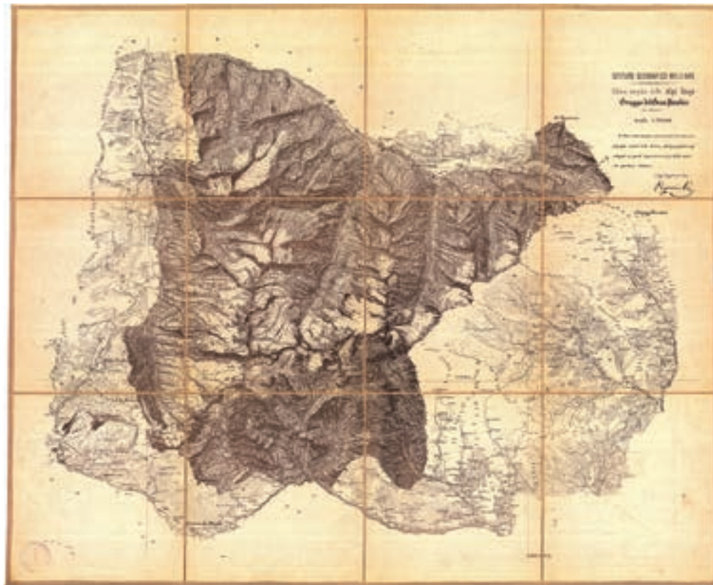
7. Gruppo del Gran Paradiso : da ultimarsi : rilievo eseguito nelle Alpi Graje , Firenze IGM 1885. Accurato e innovativo lavoro di Pio Paganini, è una delle prime carte realizzate con la fotogrammetria e segna una svolta per la cartografia alpina, col metodo della fototopografia
