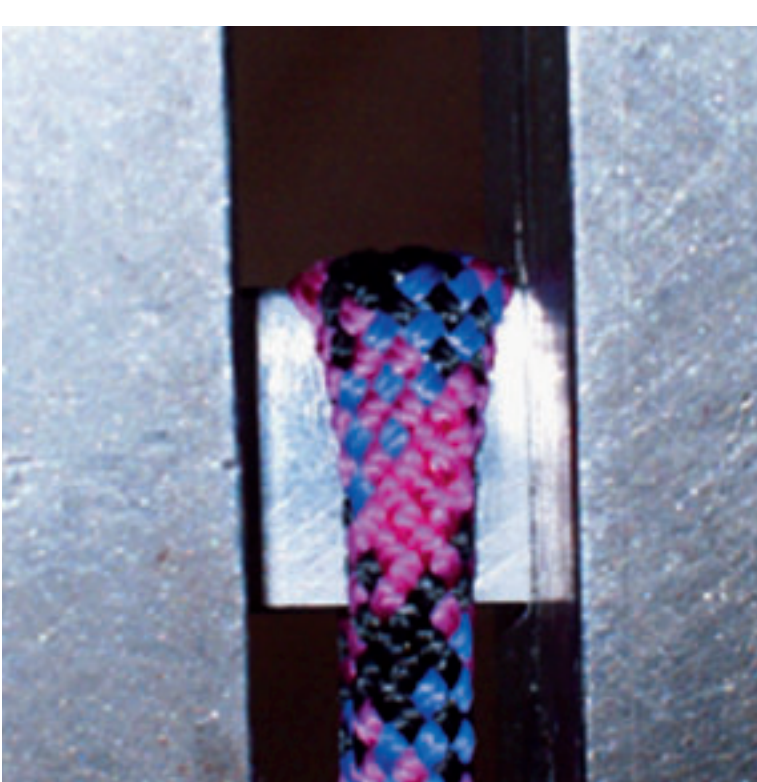
Fig. 2 effetto dello spigolo sul cordino.
