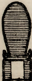
Il puntale della sonda col fendineve a goccia ed i piccoli graffi collocati alla sua base
