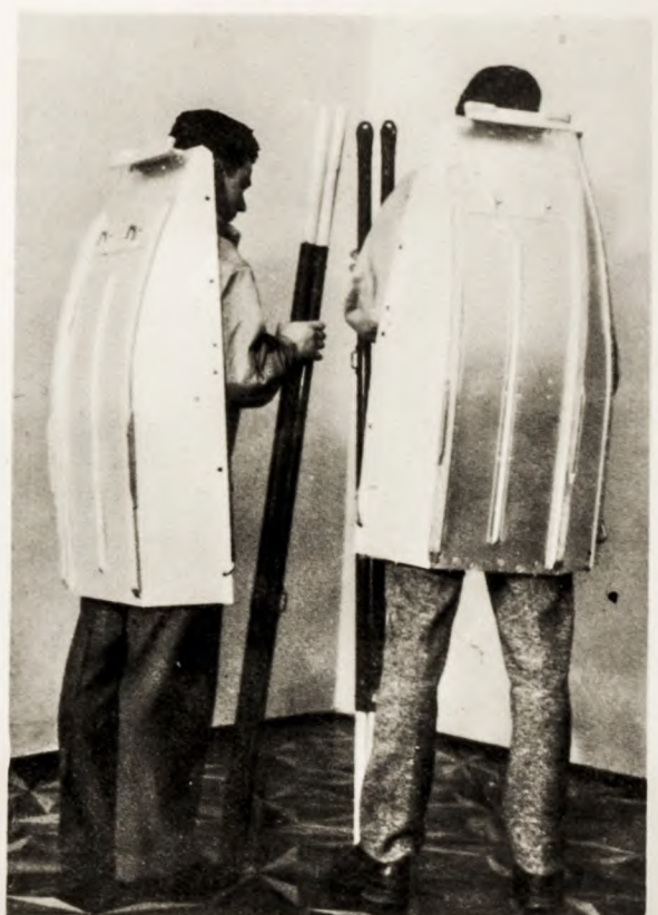
Akia in anticorodal scomponibile; misure m. 2x0,57; pattini di guida e 4 ganci per i bastoni di comando in anticorodal e impugnatura in legno con cinghie di cuoio di allacciamento.
