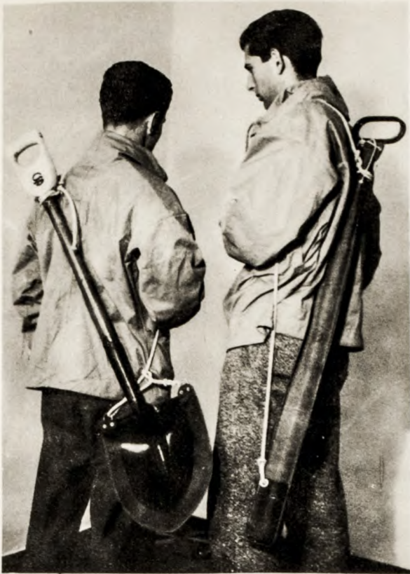
Pala per neve con fodero a bretella; sonde per valanghe (4 elementi da 1 m. cad. in acciaio con raccordi a vite in bronzo - peso kg. 4)
