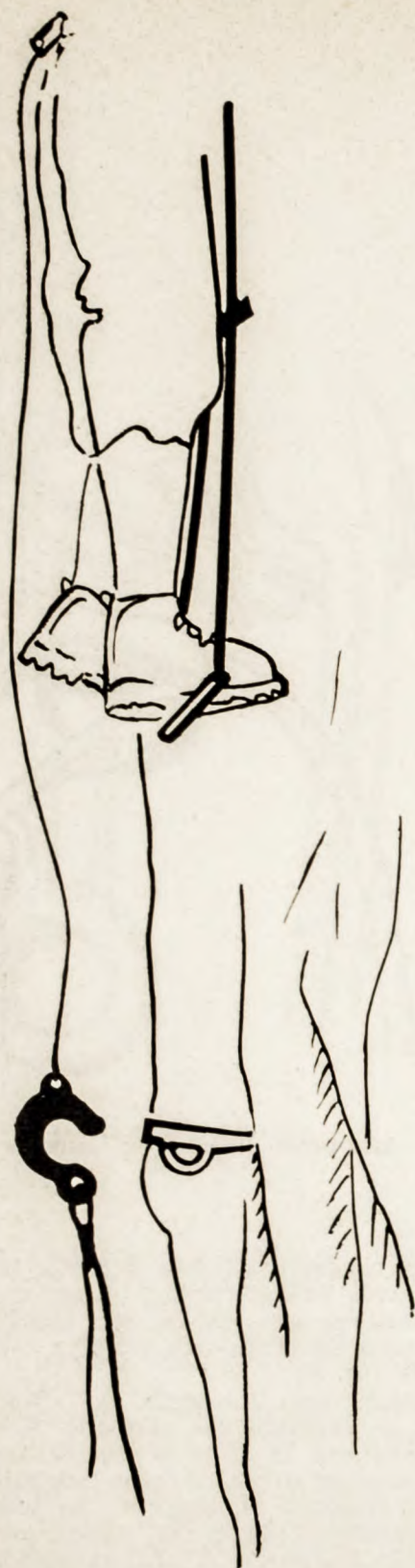
12 - Recupero di staffa mediante il gancio «fiffi».
