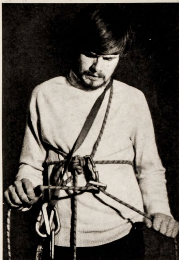
Freno Sticht: fase di bloccaggio; l'attrito è in funzione dell'angolo fra le due corde.
