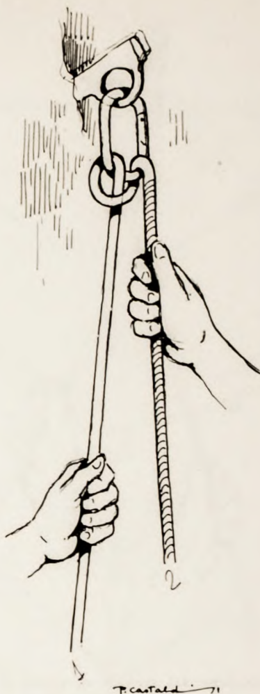
E - Nodo mezzo barcaiole (mezzo paletto) con assicurazione dal primo al secondo di cordata (corda 2).
