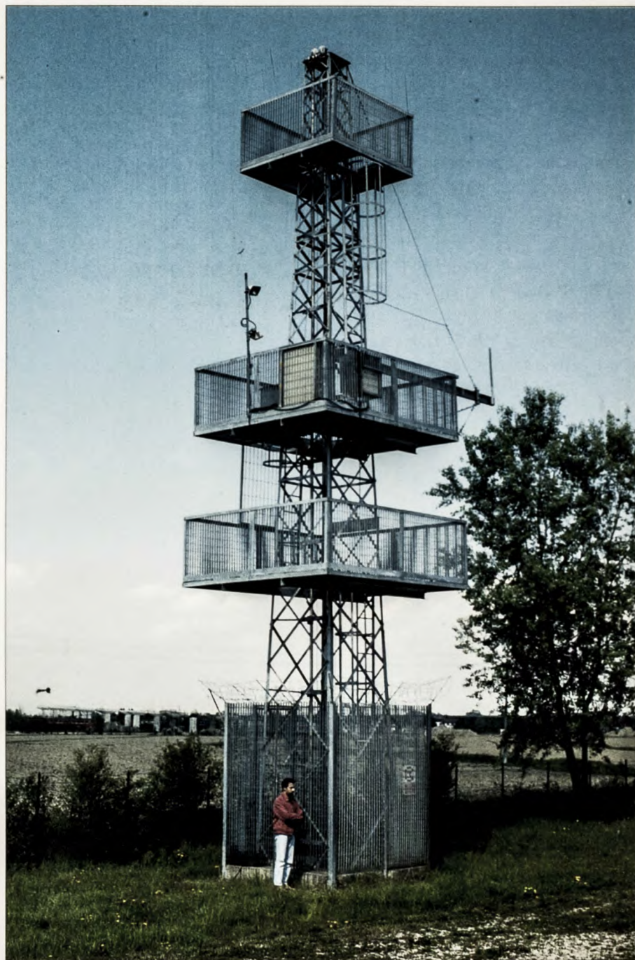
La torre adibita alle prove dinamiche sui materiali, alta 16 metri sorge alla periferia di Padova
