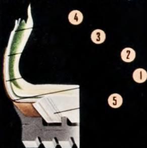
5. "W.P. Tape": nastro biadesivo sigillante che impedisce all'umidità esterna di entrare a contatto con l'interno.
