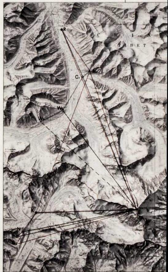
La rete dei punti geodetici dell'Everest in alzato e in pianta.
