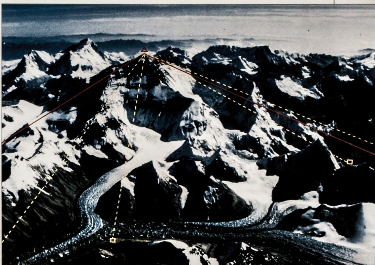
La rete dei punti geodetici dell'Everest in alzato e in pianta.
