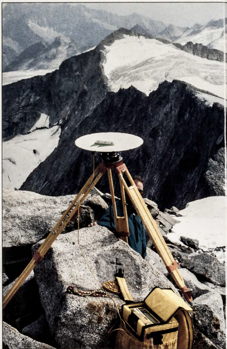
L'antenna del ricevitore gps posizionata sulla cima dell'Adamello nell'ambito delle operazioni per la misura delle variazioni frontali del ghiacciaio Adamello-Mandron.
