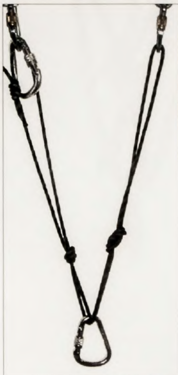
Fig. 2: Sosta fissa con unico nodo sui rami (sinistra) o nodi separati sui singoli rami (destra).
