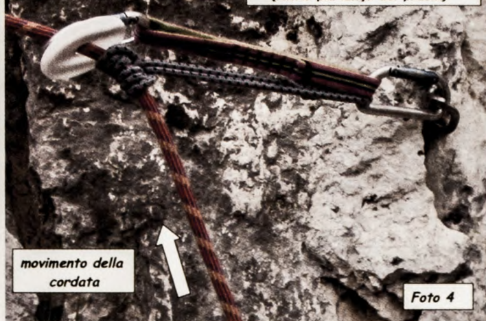
montaggio errato del dispositivo (rinvio più lungo del prusik)
